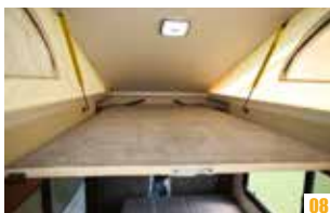
07. 冷蔵庫や電子レンジを設置するための家具。最下段の扉は、収納スペース。08. ポップアップルーフ部の2段ベッド。大人2人が就寝できる広さと強度を持つ。09. 最後輪は駆動しないため、バック時はボタン操作でリフトアックスルさせ、転がり抵抗を軽減させるシステムを採用。
